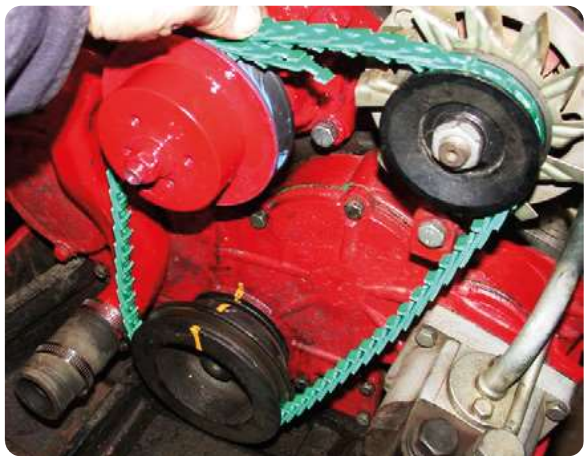
A diferencia de la correa en V convencional, se puede rodar sobre la polea: no hay cordón que se corte.
